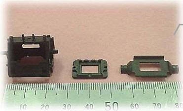
薄いガラスレンズをはさむため、平面度精度が必要な部品。膨脹係数もガラスに近いものが求められる
