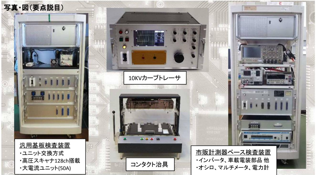
**汎用基板検査装置**
