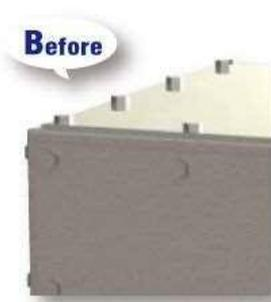
フレームにタップを切って、板のカバーをボルト止め。溶接構造のフレームはひずみやすく、カバーの取付けに手間のかかる構造。
