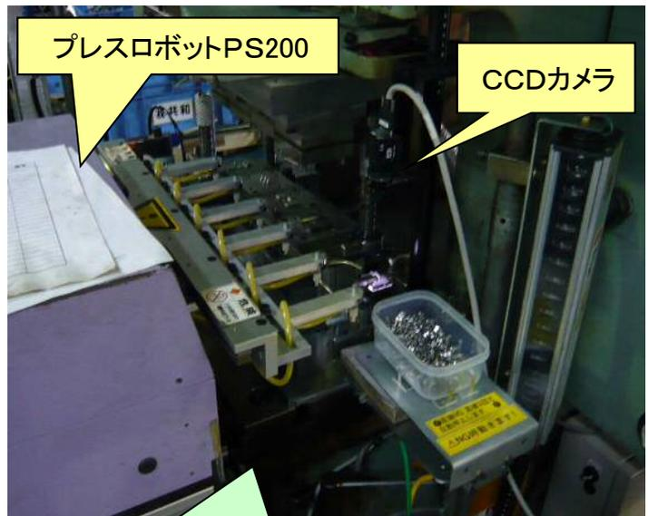
画像処理装置と組合せ、プレスインライン検査を実現!
