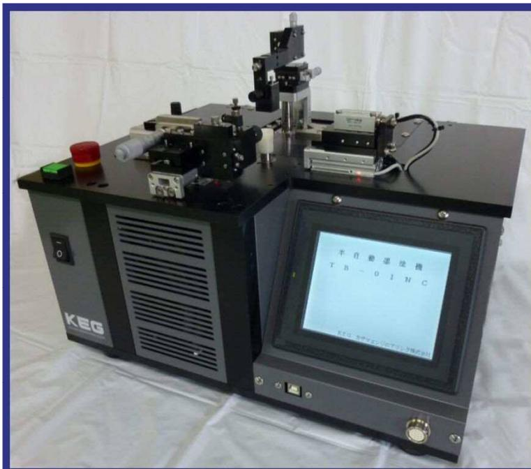
■3軸制御ロボによる複雑なレンズ形状への対応
