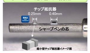
開発中の0201サイズの抵抗器と販売中の0402サイズ(0.4mm×0.2mm)の抵抗器の写真です。 携帯電話など軽さや薄さが求められる製品や 高密度実装が必要とされるウェアラブル機器等 に、このような小型電子部品が使われます。 開発中のスクリーン印刷による微細 パターン形成技術
