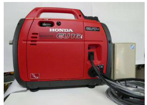
フルオート制御ガソリンエンジン発電機 1.6Kw連続3日間自動運転(商用OFFで始動ONで停止) 月1回10分間自動運転(キャブ内燃料交換) FMコミュニティー送信所多数納入(東北)
