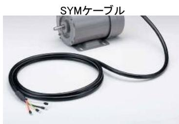
シールドを使用せずアース線と動力線3心のバランスをとり、さらに両者の間隔を近づけることでアース線のインピーダンス(ループインダクタンス)を小さくし、ノイズの影響を小さくしました。
