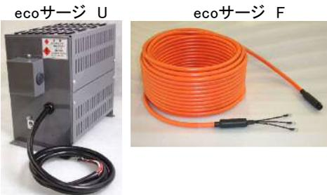
インバータ出力ケーブルと同等のインピーダンスをもつ当社独自の「サージ抑制線」を接続することでインピーダンス不整合によるサージを発生させません。また、サージ抑制線がサージ電流のみを吸収し熱に変換して消失させます(特許出願済)。
