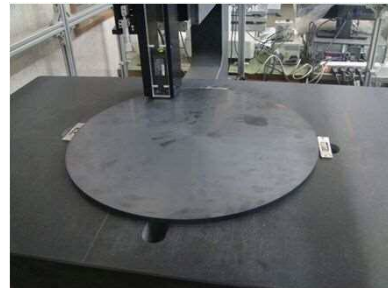
測定物: φ500SiC 平面研削加工 12μm凹面仕上げ
