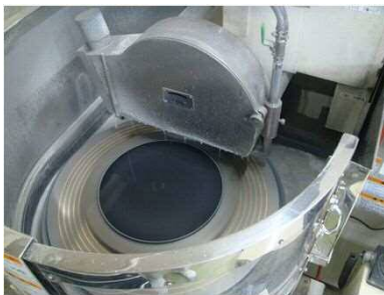
測定物: φ500SiC 平面研削加工 12μm凹面仕上げ
