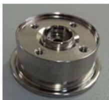
HDD部品(材質:SUS)
