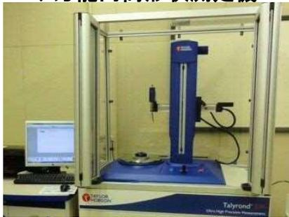
**ここが精密!** 製品の真円度(丸さ)、円筒度、真直度、表面粗さなどを評価する装置です。非常に高い回転精度を持つ回転テーブルと最高0.3nmの分解能を持つ検出器により、きわめて高精度に評価できます。
