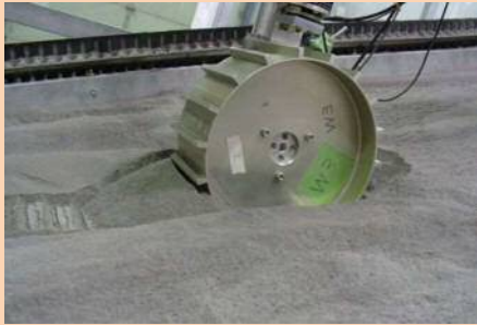
車輪が地盤に埋まる様子
