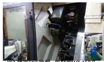
図2.精密CNC旋盤 中村留WT-150 II(φ20~φ65の外径サイズを旋盤・複合加工)
