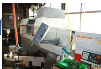
図1.CNC自動旋盤Cincom L20E 9型(φ3~φ20の外径サイズを旋盤・複合加工)
