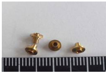
入口からφ1.2 L3.3 内径穴の バック面取りを処理後 突っ切り
