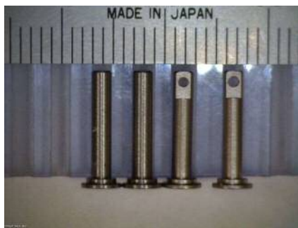
携帯電話ヒンジ 二次加工:フライス+横孔
